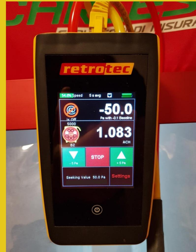
A lavori ultimati, l'edificio è stato sottoposto al Blower Door Test, una prova empirica che permette di misurare la permeabilità dell'aria di un edificio e quindi di verificare la corretta esecuzione dell'involucro (tenuta all'aria, posa isolamenti, posa serramenti, posa impianti, ecc...)
