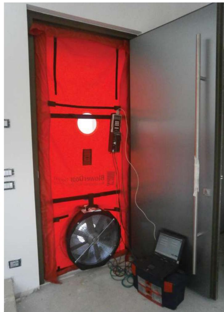
Per verificare la tenuta all'aria dell'edificio, è stato eseguito il Blower Door Test, obbligatorio per ottenere la certificazione CasaClima.
